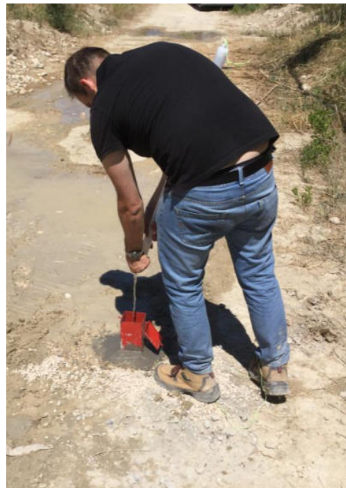
Figura 3. Immagine di repertorio - freatimetro
