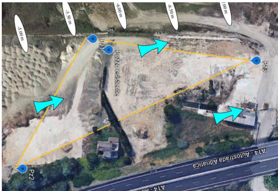
Figura 2. Isopiezometriche dell'acquifero in esame e direzione di falda
