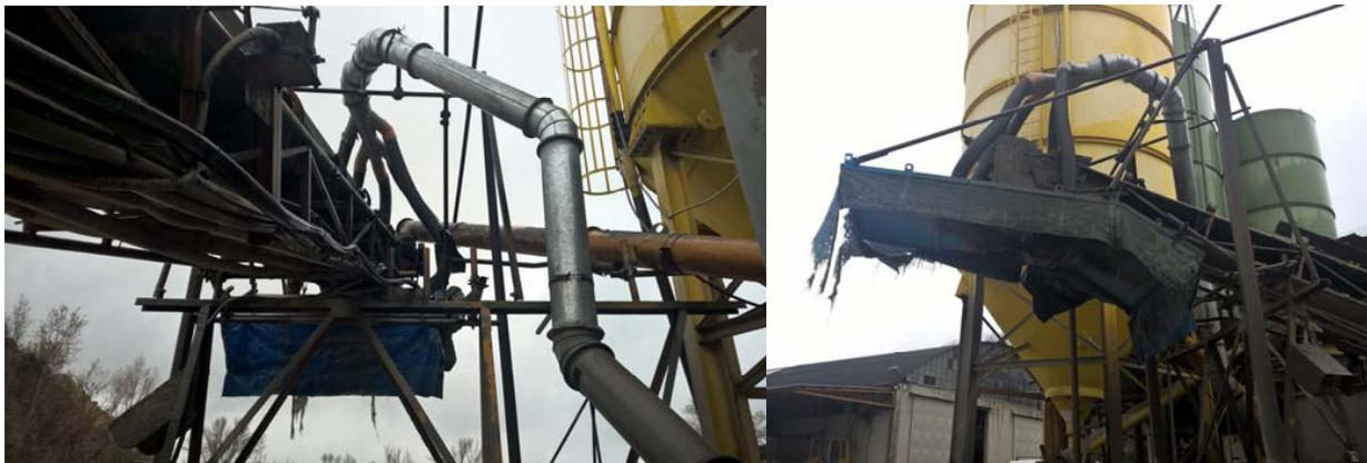
*Bocca di carico impianto di betonaggio e sistema di aspirazione polveri*
