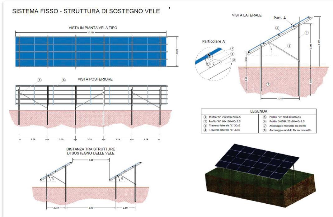
Figura 4 – Strutture di sostegno (vista laterale, dall'alto, sketch 3D)
