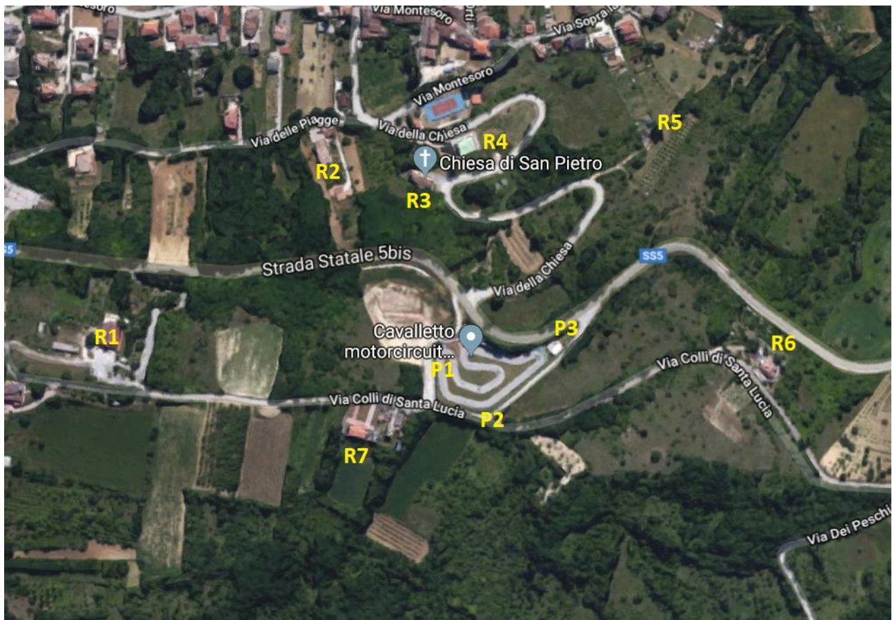
Figura 3 – Recettori acusticamente più sfavoriti (R1, R2, R3, R4, R5, R6, R7) e punti di misura (P1, P2, P3).
