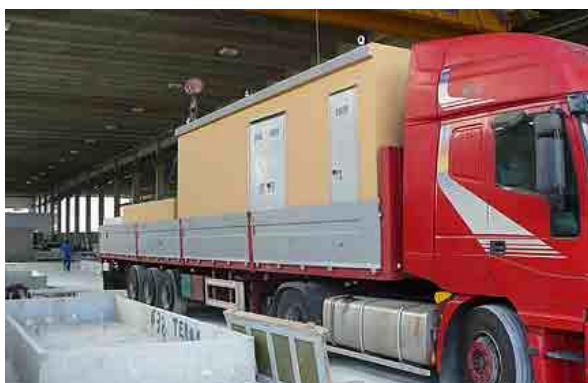
Trasporto cabine elettriche da parte di autocarri con gru
