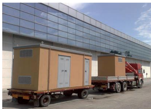
Trasporto cabine elettriche da parte di autocarri con gru
