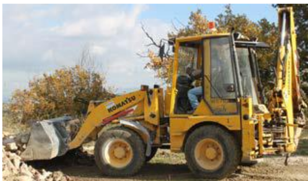
Escavatore caricatore (Terna)
