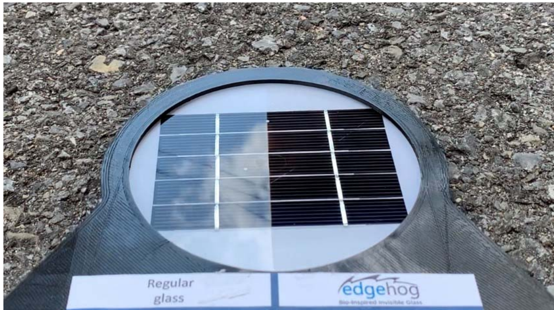
Figura 3: Le due immagini dimostrano in modo lampante come, al contrario di un vetro comune (normal glass), il vetro anti-riflesso (Anti-Reflecting glass) che riveste i moduli fotovoltaici (Photo Voltaic Modules) riduca drasticamente la riflessione dei raggi luminosi
