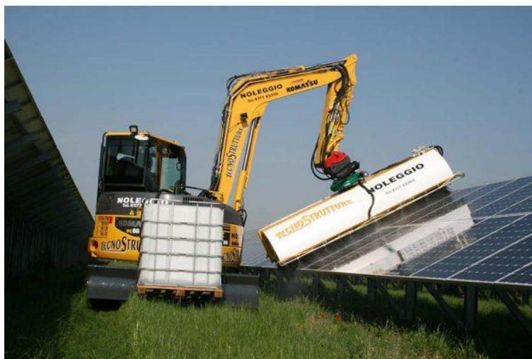
Esempio di sistema di lavaggio moduli fotovoltaici.
