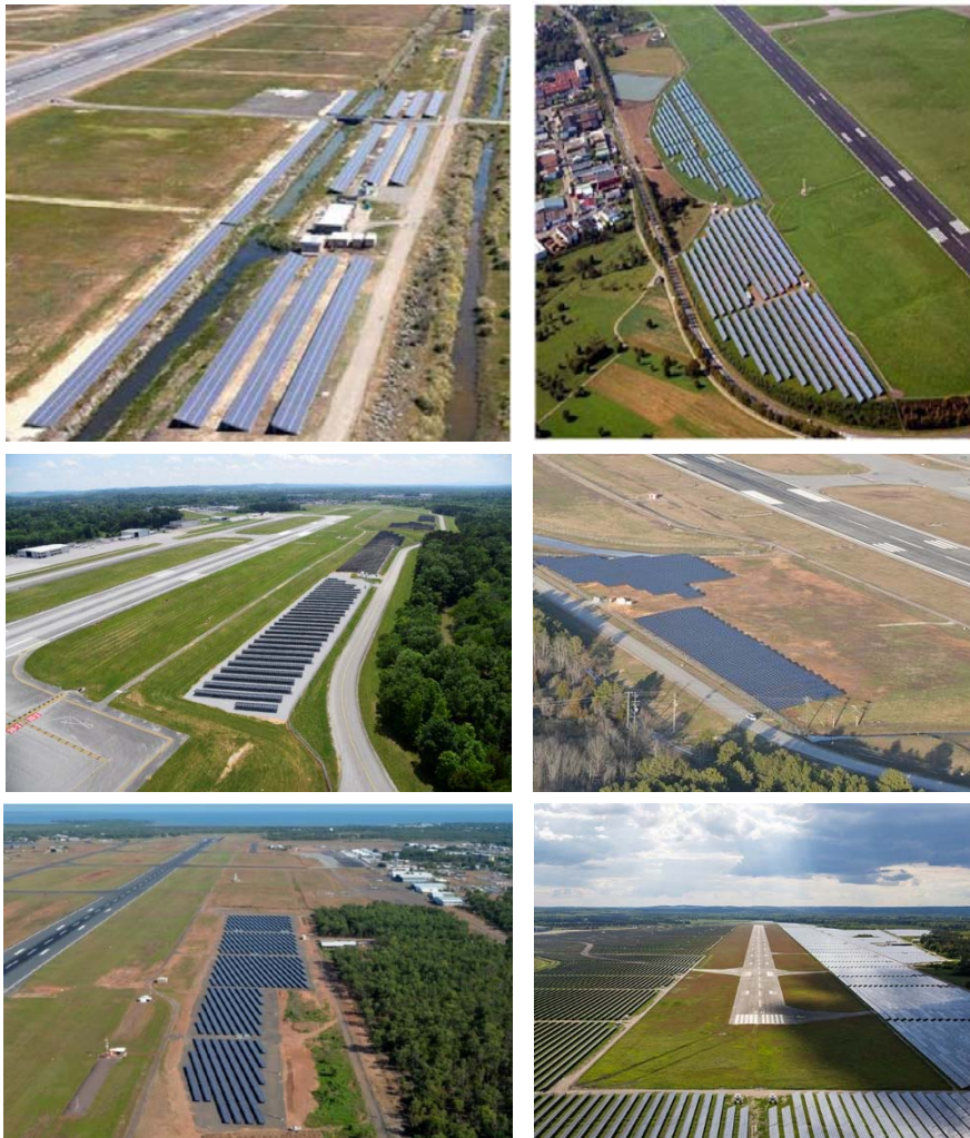
Figura 4: Esempi di impianti fotovoltaici in ambito aeroportuale. La disposizione dei moduli fotovoltaici in prossimità delle piste di atterraggio/decollo non rappresenta un rischio per la sicurezza.
