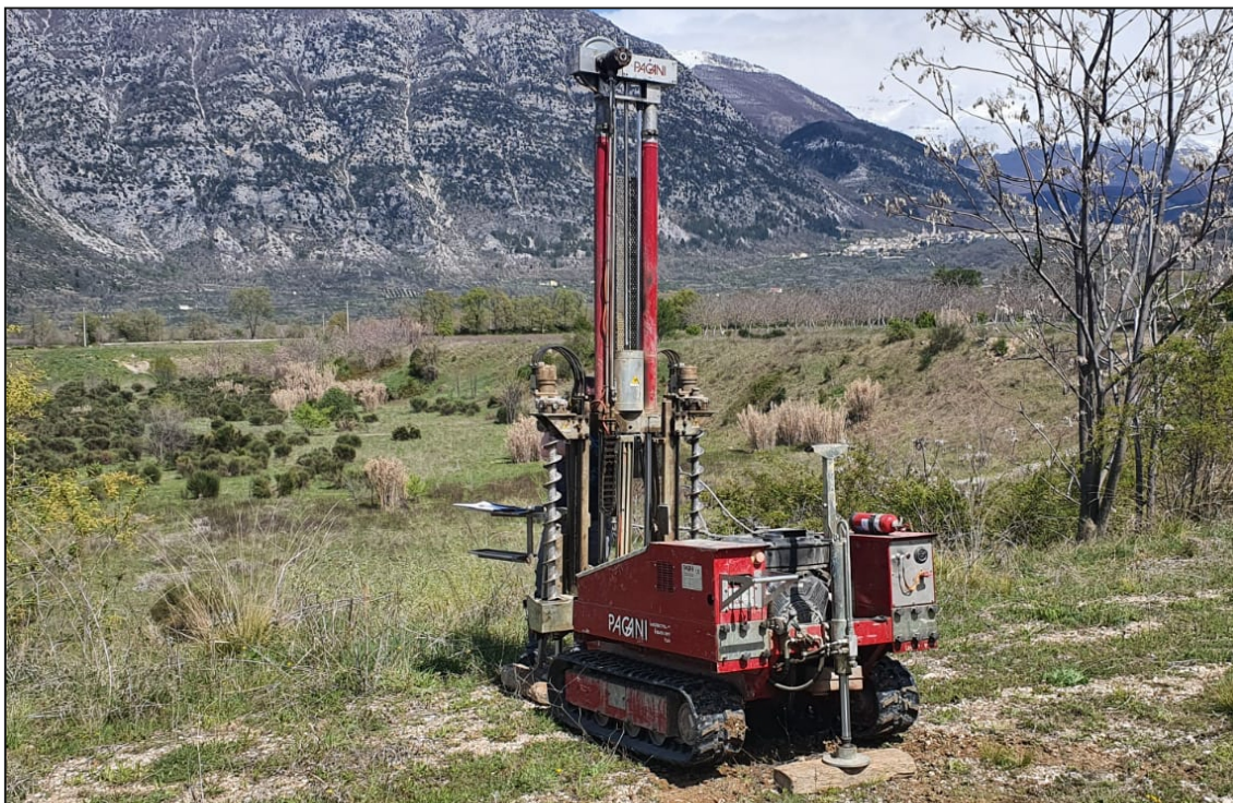
Ubicazione prova penetrometrica dinamica continua (DPSH 1)
