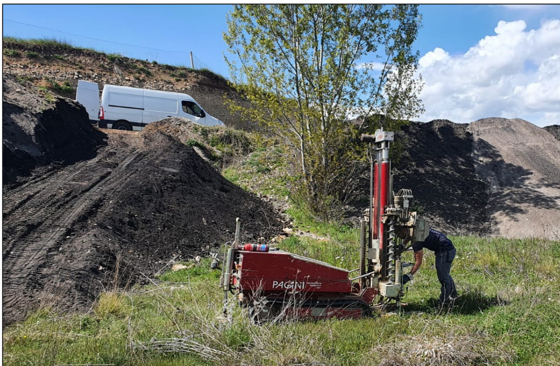
Ubicazione prova penetrometrica dinamica continua (DPSH 2)
