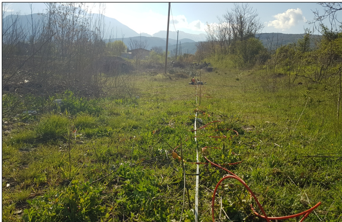
Ubicazione stendimento sismico multicanale M.A.S.W. (MW 1) e tomografia sismica 2D (SRT 1)
