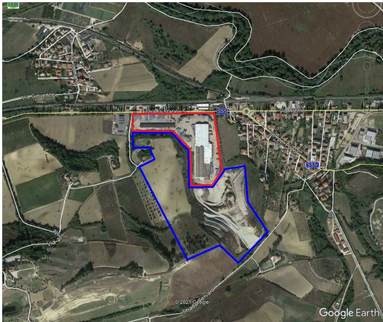
Fig. 6. Inquadramento Google Earth - In rosso evidenziata area produzione laterizi - in blu evidenziata area estrazione argilla
