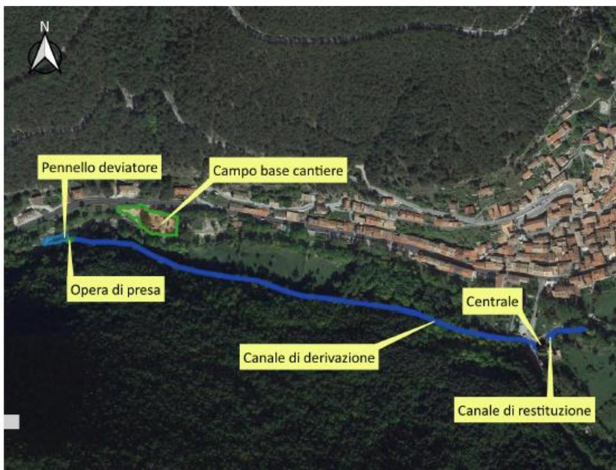
Viene riportato che la centrale idroelettrica converte l'energia idraulica proveniente dalle portate idriche derivate a monte dal Fiume Sangro, in energia elettrica secondo lo schema di impianto tipo definito "ad acqua fluente", prevedendo una quantità massima da derivare fissata in 6.000 l/s (media 4.000 l/s) con una potenza nominale pari a 352,94 kW, come da concessione di derivazione prot. 6338 del 19/10/1995.
