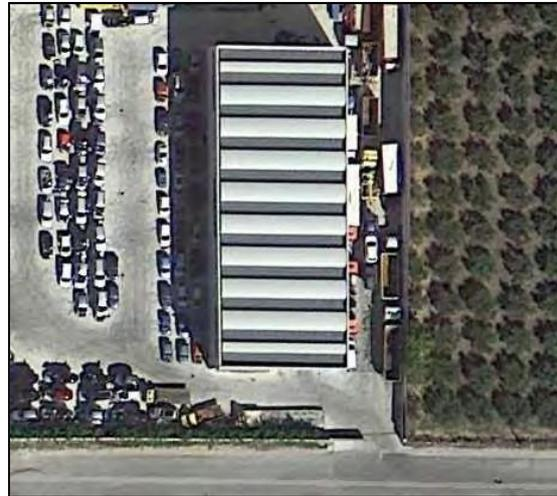
Gli opifici oggetto di autorizzazione sono stati realizzati in struttura prefabbricata. L'accesso avviene per mezzo di due portoni industriali mentre l'illuminazione naturale è garantita dalla presenza di lucernai lungo tutte le superfici; i due capannoni sono collegati mediante un accesso carrabile.
