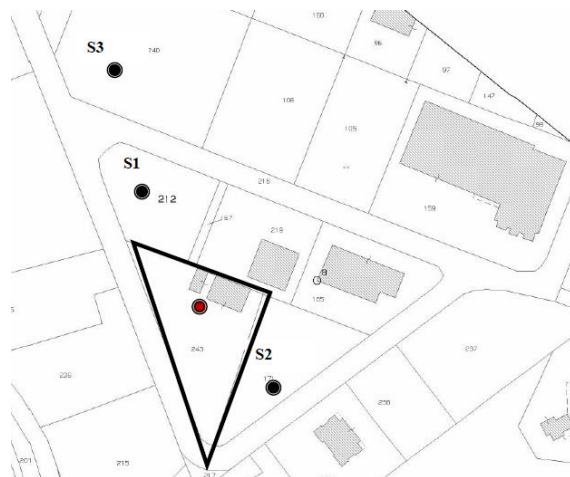
Fig. 3: ubicazione delle indagini geognostiche
