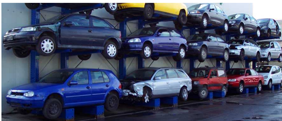
Figura 1 - Immagine esemplificativa delle modalità di stoccaggio dei veicoli su cantilever
