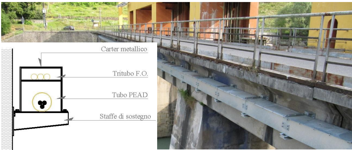
Immagine di riferimento di uno staffaggio elettrodotto su ponte
