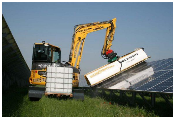
Esempio di sistema di lavaggio moduli fotovoltaici.
