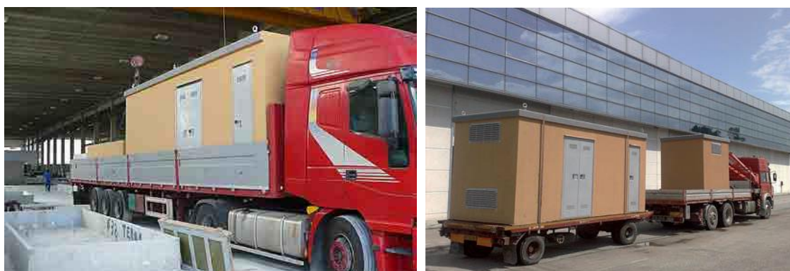
Trasporto cabine elettriche da parte di autocarri con gru
