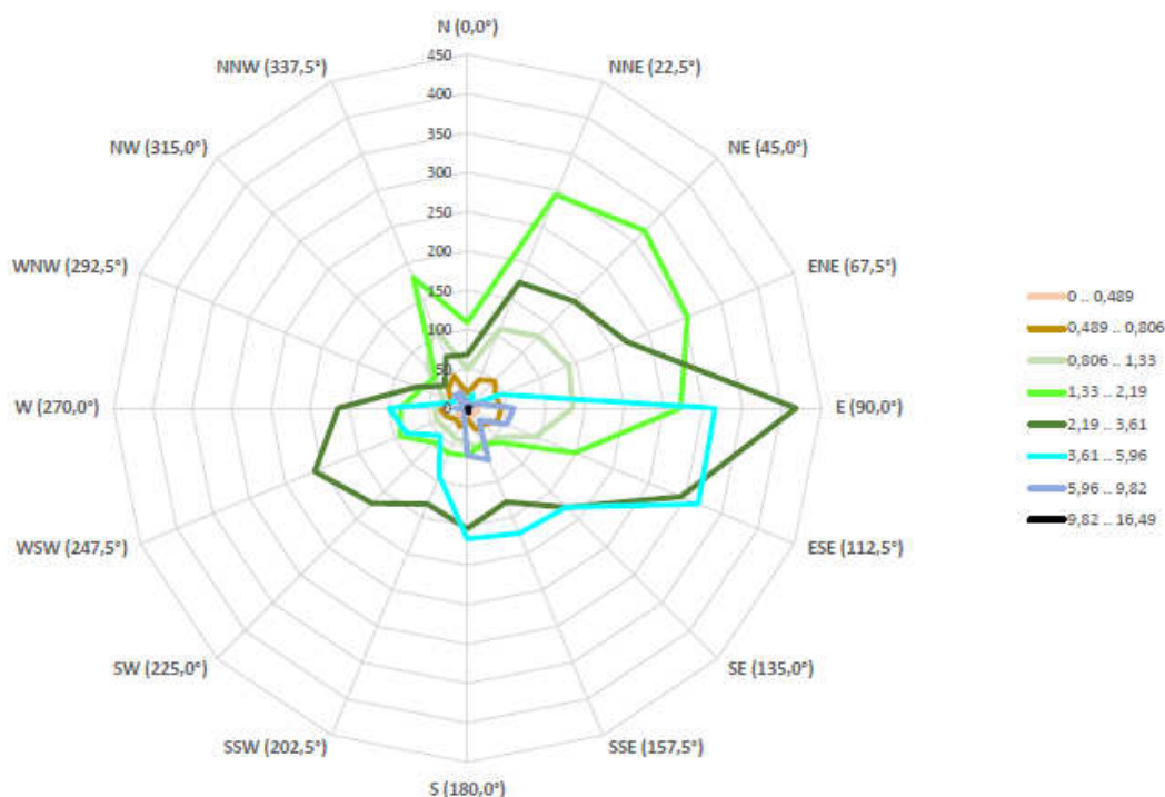
Figura 7 – Rosa dei vettori del vento secondo la classe di velocità del vento (m/s)
