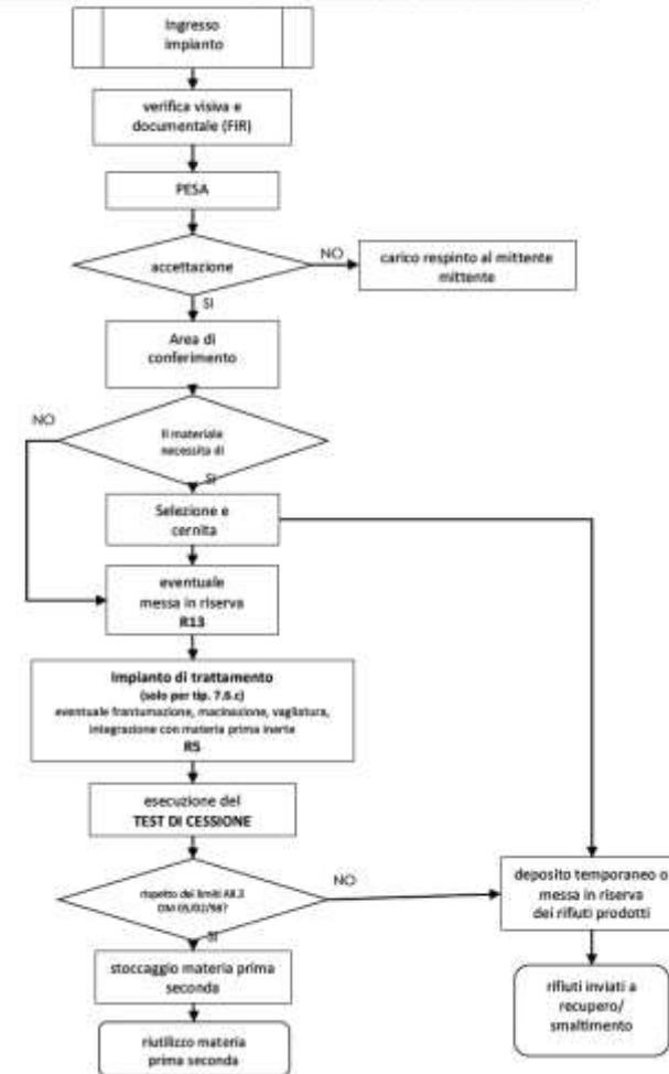
Fig. 4: schema di flusso dell'impianto
