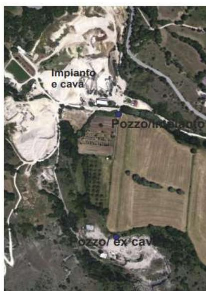
Per meglio definire l’assetto idrogeologico puntuale sono stati realizzati tre nuovi piezometri spinti fino alla profondità di 25 m dal piano campagna. I tre nuovi piezometri sono stati realizzati con la tecnica della distruzione di nucleo, e si riportano di seguito le localizzazioni e i livelli misurati dal tecnico, da cui si evince che sono sempre risultati sterili.
