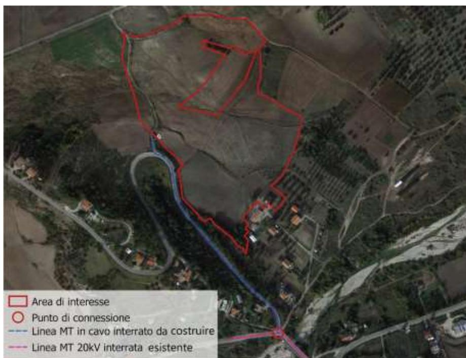
La connessione dell'impianto sarà in Media Tensione attraverso un Cavidotto interrato, di lunghezza pari a 530 m, di cui 460 su strada comunale “Contrada Peschiola”, che collegherà la Cabina di Consegna utente del Campo FV, alla linea MT esistente denominata “Terna D52042040”, tramite giunzione tra cavi interrati.
