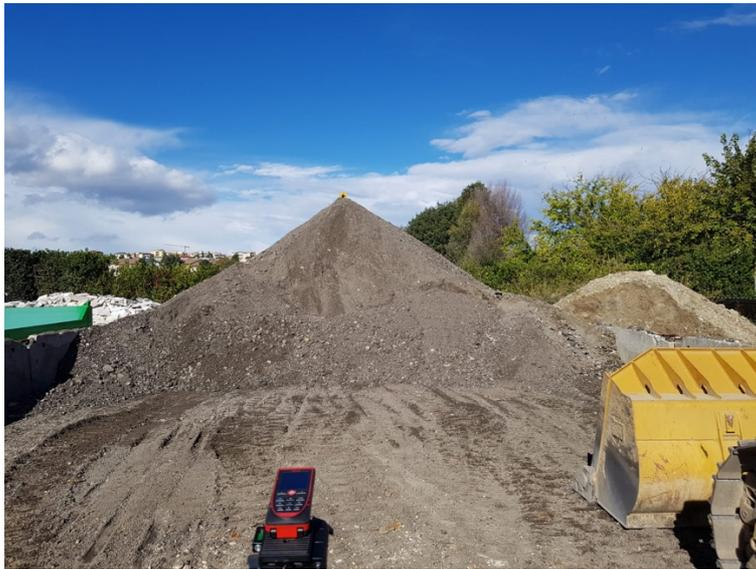
Grazie al rilievo in campo è stato possibile determinare con maggiore precisione le altezze, quote e ingombri reali e quindi definire con più esattezza i volumi dei cumuli rispetto ai calcoli solo stimati e ipotizzati in fase di presentazione dell'istanza (i cumuli erano stati approssimati a dei coni il cui volume era stato calcolato semplicemente secondo la formula:  $V = (A_{base} \times altezza)/3$ ).
