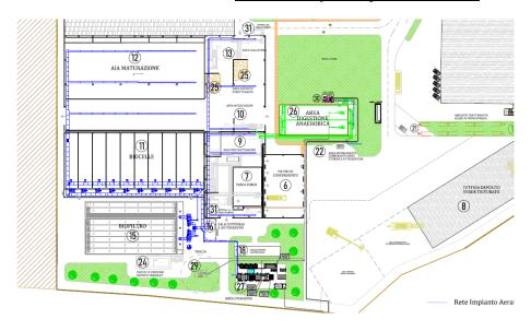
Il tecnico riporta inoltre che verrà apportata una modifica alle modalità di areazione delle biocelle e delle platee di compostaggio autorizzate. Sarà realizzato un pavimento areato con pettine di tubazioni in pvc e coni diffusori annegati in platea di cemento.
