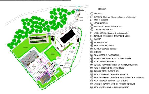
Viene descritto che attualmente il trattamento cui viene sottoposto il materiale è basato su un processo aerobico, che si svolge secondo le fasi di ACT (bio-ossidazione accelerata in biocelle) della durata di 18 giorni; CURING (maturazione secondaria su platee areate) della durata di 39 giorni e stoccaggio finale di 33 giorni, con vagliatura finale. Il tecnico riporta anche le tipologie di rifiuti e le quantità ammesse in impianto:
