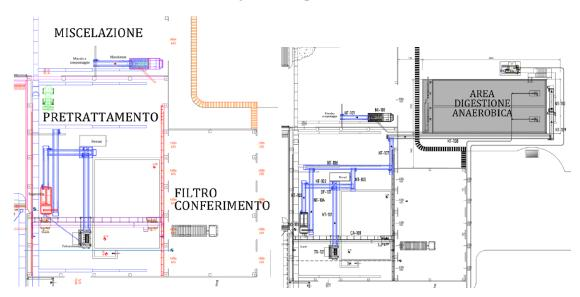
La sezione di pretrattamento consta di un trituratore, un deferrizzatore ed un separatore TIGER. **Tramite** appositi nastri bidirezionali ed a seconda della ricetta di carico, il materiale viene inviato al digestore anaerobico.
