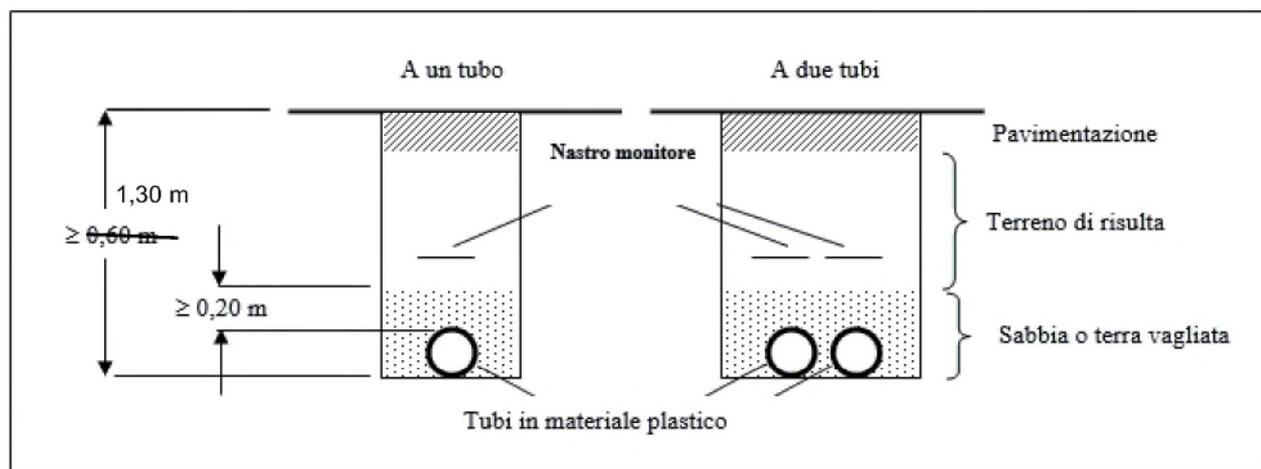
Canalizzazioni a profondità minore possono essere realizzate con tubo rinfiato da un bauletto di calcestruzzo di spessore minimo 10 cm da ogni parte.
