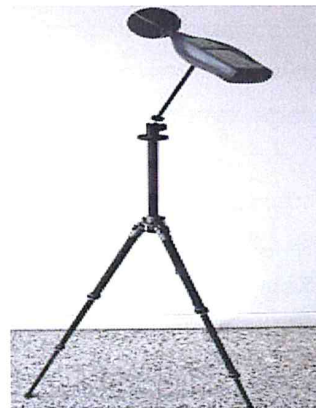
Figg. 2 e 3 Fonometro utilizzato per i rilievi fissato su treppiede e provvisto di cuffia antivento
