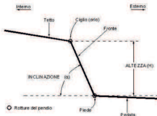
FIG. 1 - FISIOGRAFIA DI SCARPATA
