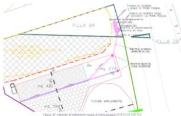
Nella fase di cantiere sarà realizzato un nuovo impianto di raccolta e smaltimento delle acque di prima pioggia da accoppiare all'impianto esistente.
