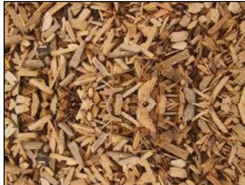
Figura 17: Particolare del materiale biofiltrante.
