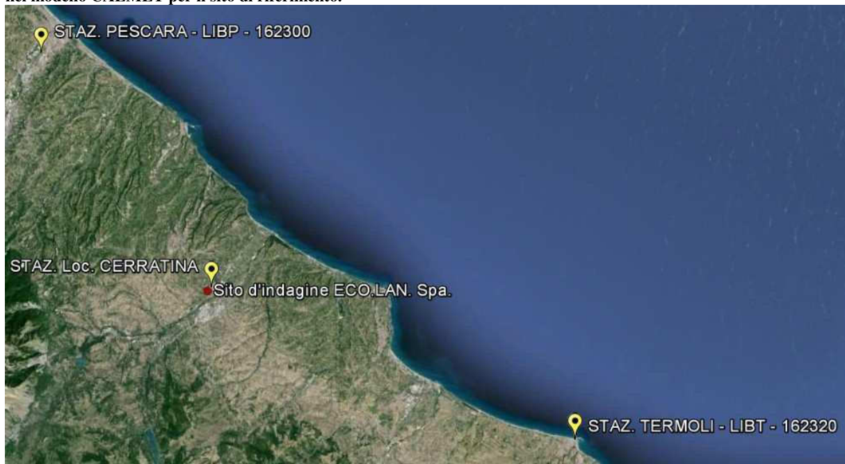
Figura 2-Stazioni meteo SYNOP – ICAO e centralina meteo in località Cerratina, utilizzate per l'analisi meteorologica nel modello CALMET per il sito di riferimento.
