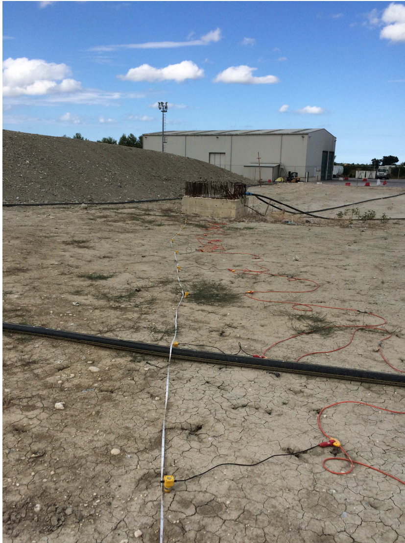
Foto: ubicazione stendimento Masw nell'ammasso rifiuti
