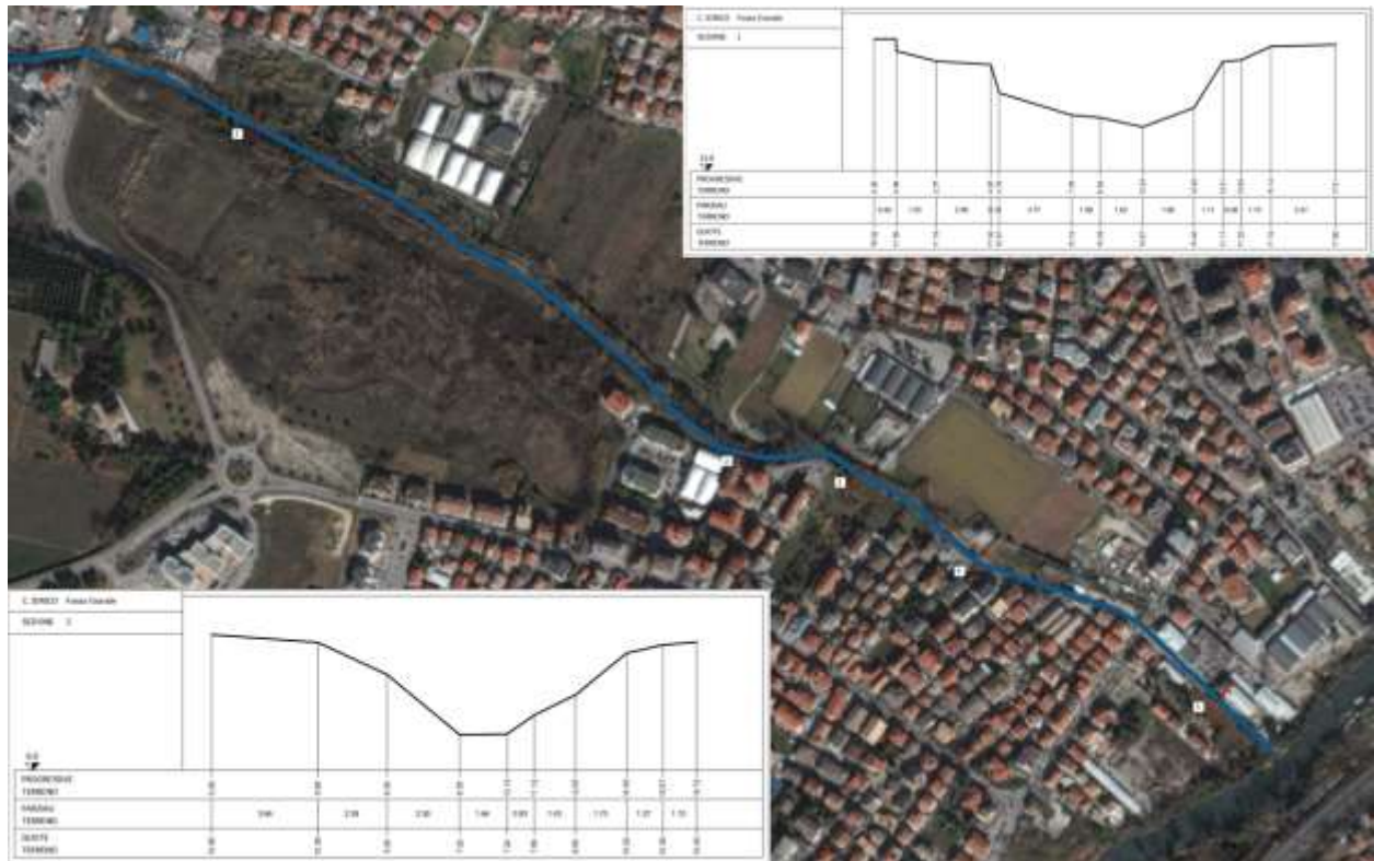
Figura 3.6: Stralcio planimetrico riportante lo sviluppo del tratto di interesse del Fosso Grande, con indicazione di alcune sezioni rilevate.
