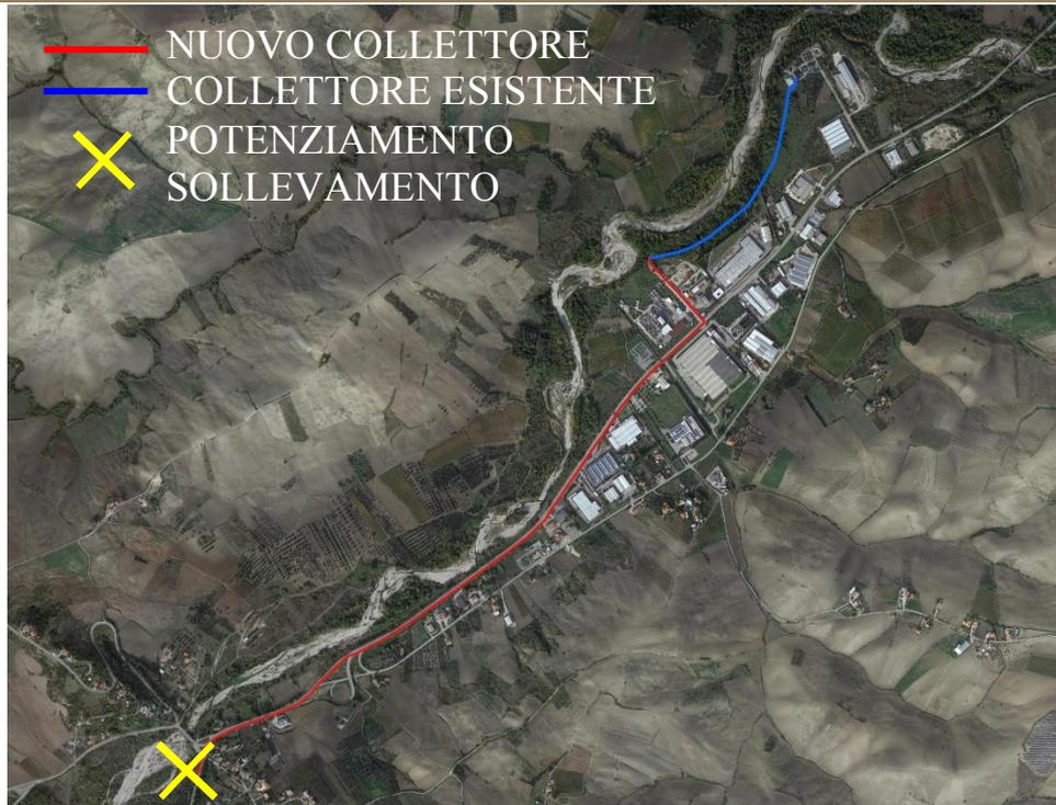
Figura 4-3 - Interventi sul collettore fognario a monte dell'impianto di depurazione
