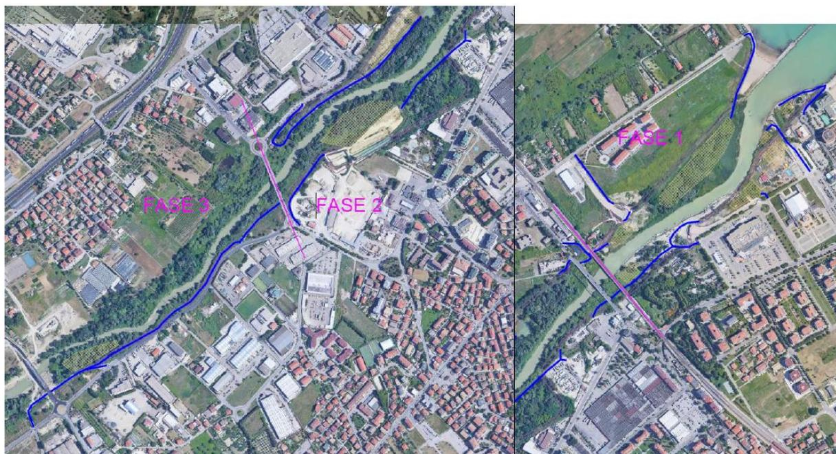
Figura 10 - Piste di cantiere e aree di deposito.
