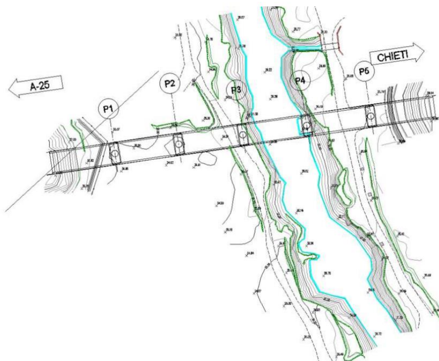
Figura 4-1 Rilievo celerimetrico della zona di intervento
