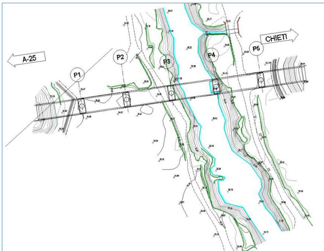
Figura 6 – “Rilievo celerimetrico della zona di intervento in corrispondenza del Viadotto Pescara 2°”
