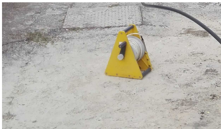
Fig.4– Misurazione livello piezometrico mediante sonda freaticometrica
