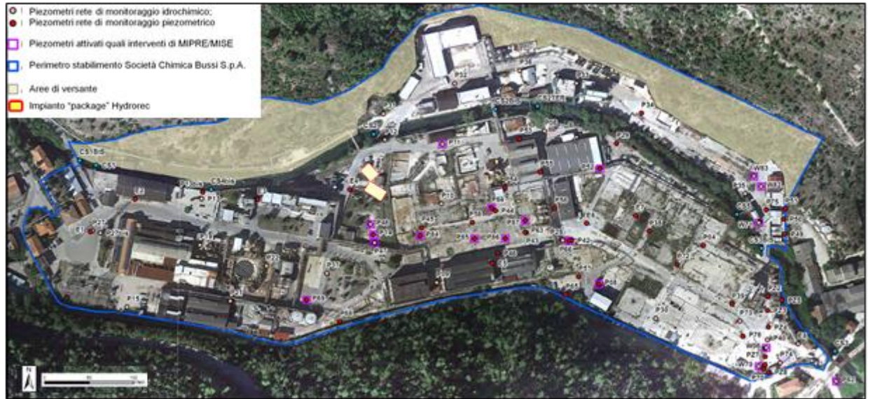
Figura 28: Interventi di MIPRE/MISE attivi in sito in falda superficiale e ubicazione nuovi impianti
