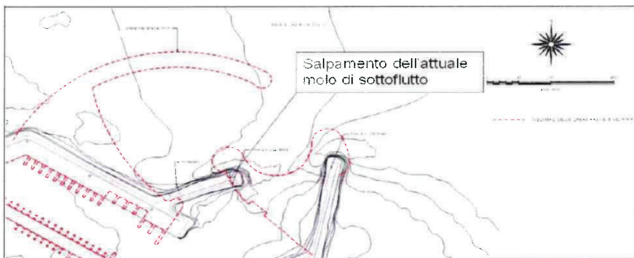
Fig. 11 – Sovrapposizione tra le opere previste dal PRP (in rosso) e lo stato attuale.
