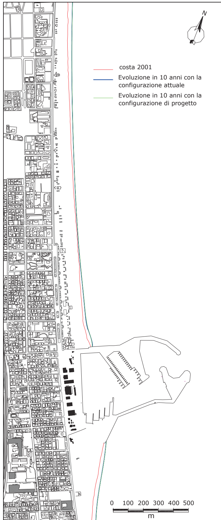
Figura 101 – Evoluzione della linea di costa nei prossimi 10 anni, con la configurazione di progetto (linea verde), confrontata a quella che si avrebbe con la configurazione attuale (linea blu).
