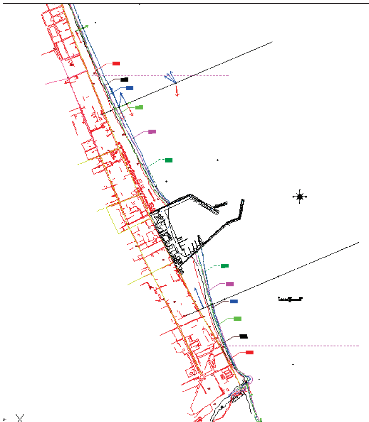
Figura 80 - Schema di prevalente distribuzione dei materiali in regime di alta energia ricavato attraverso McLaren
