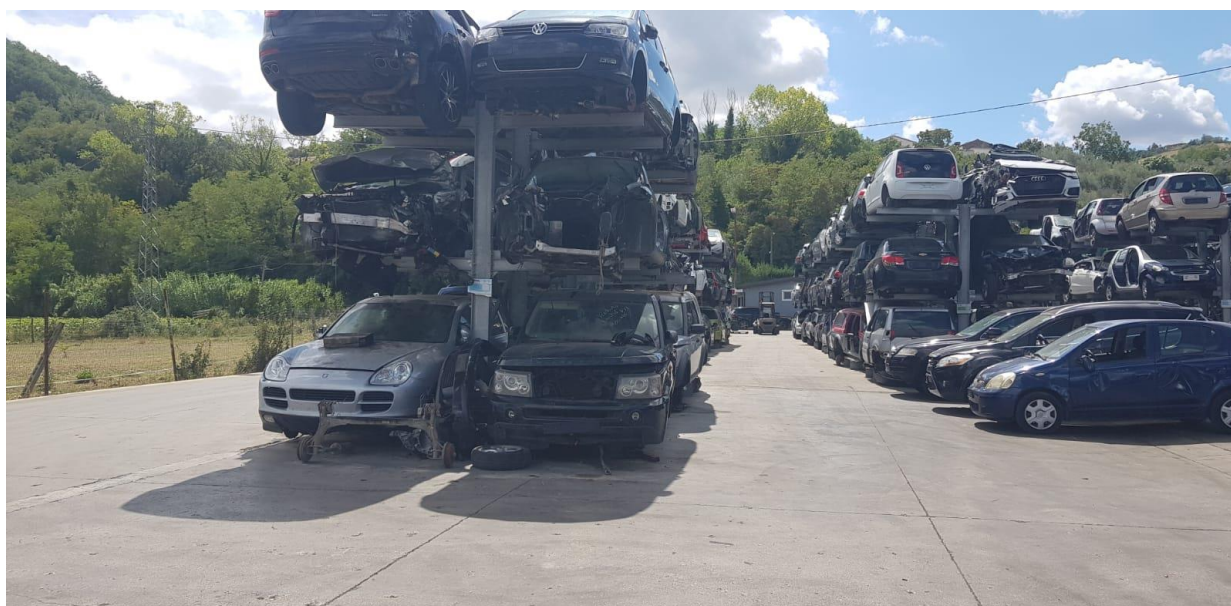
Fig. 26 – Particolare area stoccaggio vetture messe in sicurezza su cantilever
