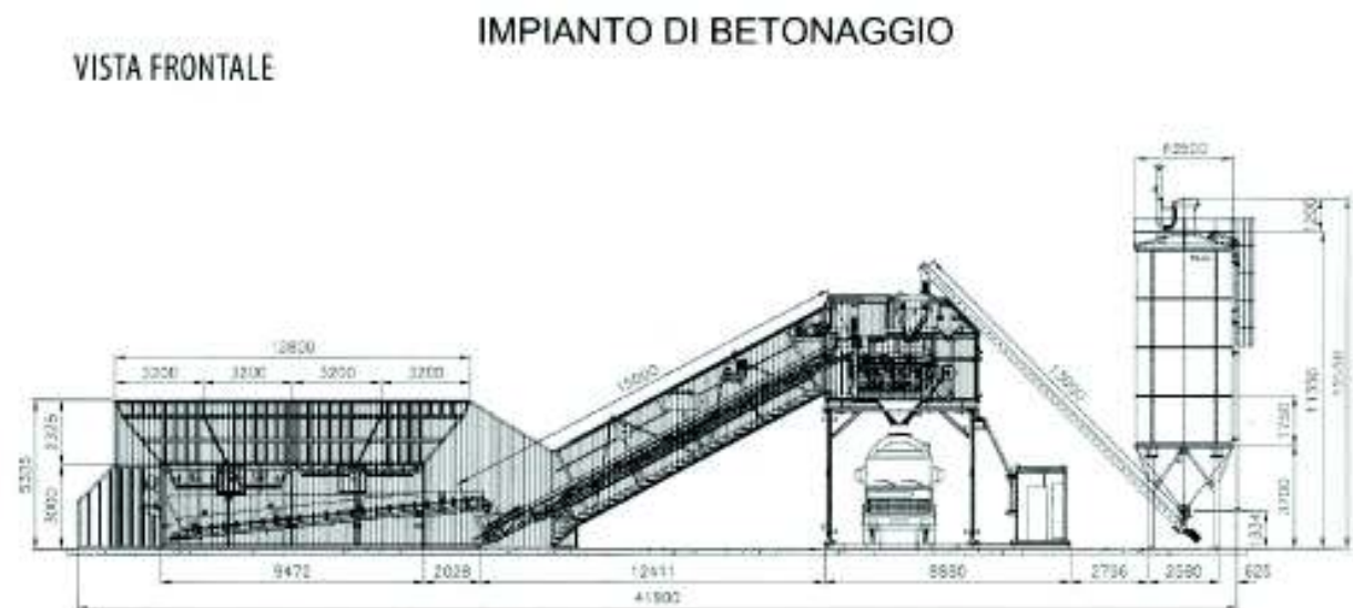
Figura 3 Impianto di betonaggio
