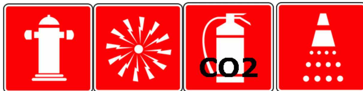
Figura 22 Attacco Vigili del Fuoco – Sirena di allarme - Estintore CO 2 – Impianto di spegnimento/raffreddamento automatico
