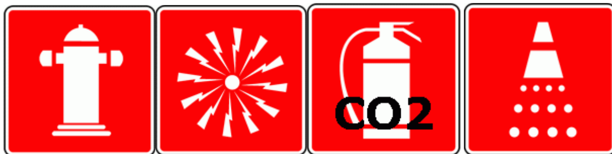
Figura 5 Attacco Vigili del Fuoco – Sirena di allarme - Estintore CO 2 – Impianto di spegnimento/raffreddamento automatico
