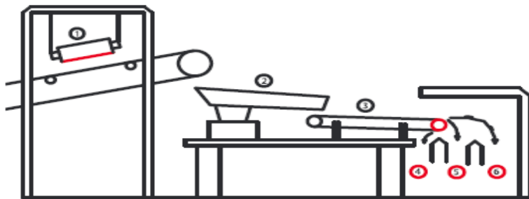
Figura 4 – Separatore magnetico schematizzato
