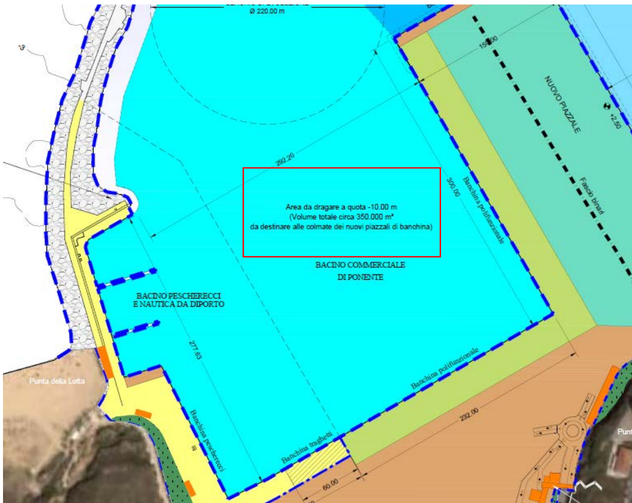
Figura 16. Planimetri di Progetto FP – 01 del Piano Regolatore Portuale. Il rettangolo rosso indica la previsione di cui si parla in merito alle opere di dragaggio ossia di portare il fondale del porto ad una quota di – 10 rispetto al livello del mare.
