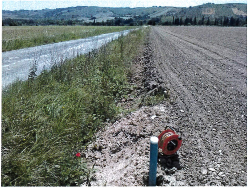
Foto 3, 4: letture freatiche con sonda galvanometrica ai piezometri S1 e S2
