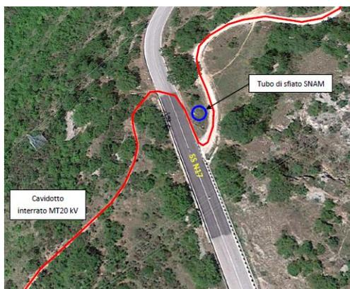
Figura 12 Dettaglio interferenza
