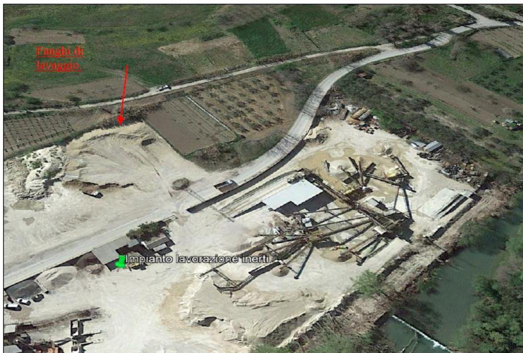
Figura 8 – Veduta aerea dell'impianto di lavorazione del materiale di cava e dell'area di stoccaggio dei fanghi di lavaggio
