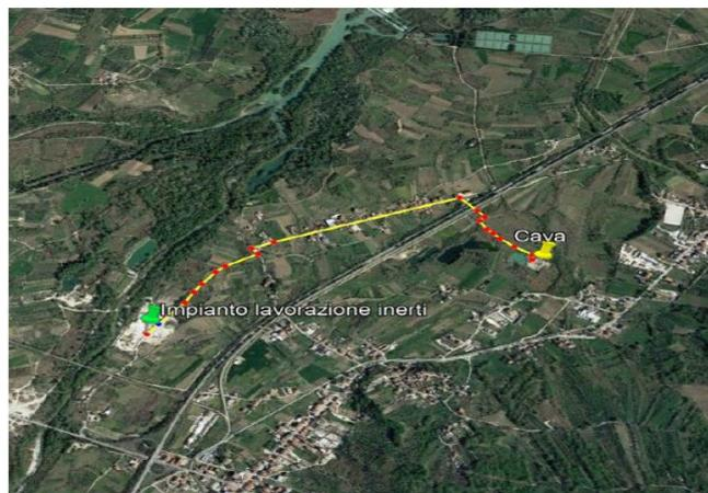
Figura 2 - Percorso alternativo a quello di figura 1, da preferire nei periodi di tempo asciutto ad evitare il sollevamento massivo di polveri.
