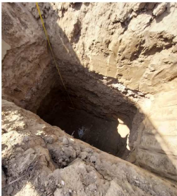
P2-Sondaggio 2: H scavo 6,60 - q.f. +36,00 - q.t. +42,60
