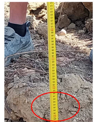
P3-Sondaggio 3: H scavo 6,70 - q.f. +37,10 - q.t. +44,70
