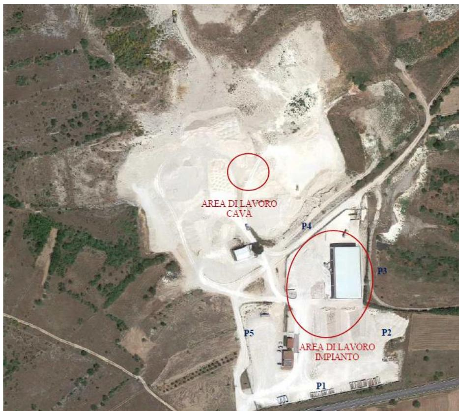
Stralcio aereofotogrammetrico n. 8: Posizione punti di misura P delle Emissioni Sonore
