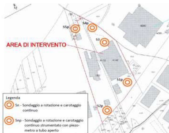
Fig. 6.: ubicazione dei sondaggi
