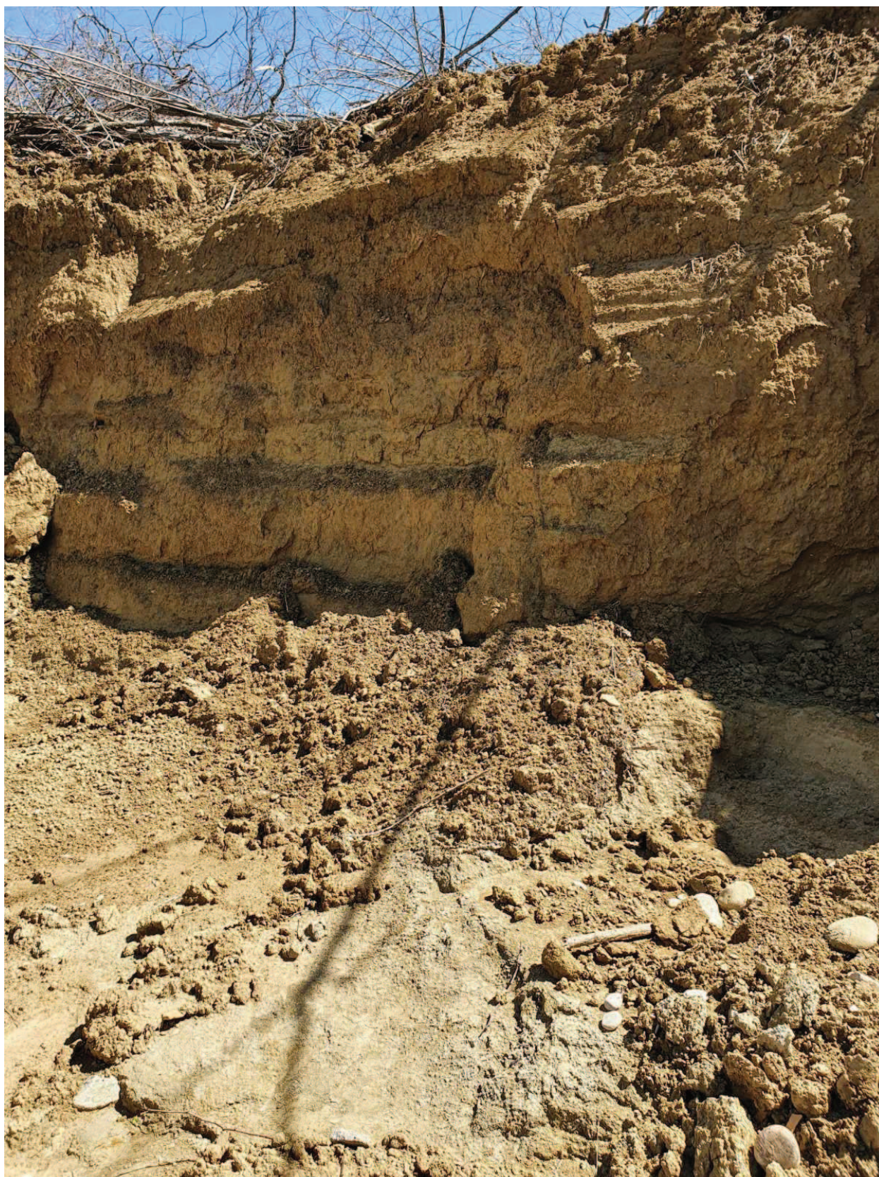
Fronte di scavo e stratigrafia dei terreni colluviali, spessore 4,40m, presenti al di sopra del deposito alluvionale
