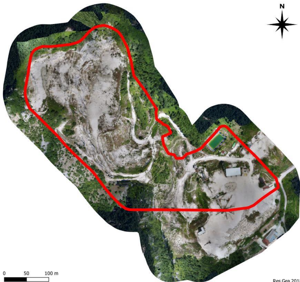
Figura 5: Ortofoto ad altissima risoluzione (5 cm/pixel) prodotta dalle elaborazioni fotogrammetriche per l'area di studio.
