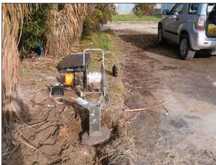
Foto 5 – Spurgo e campionamento del piezometro Pz1 con pompa low flow.
