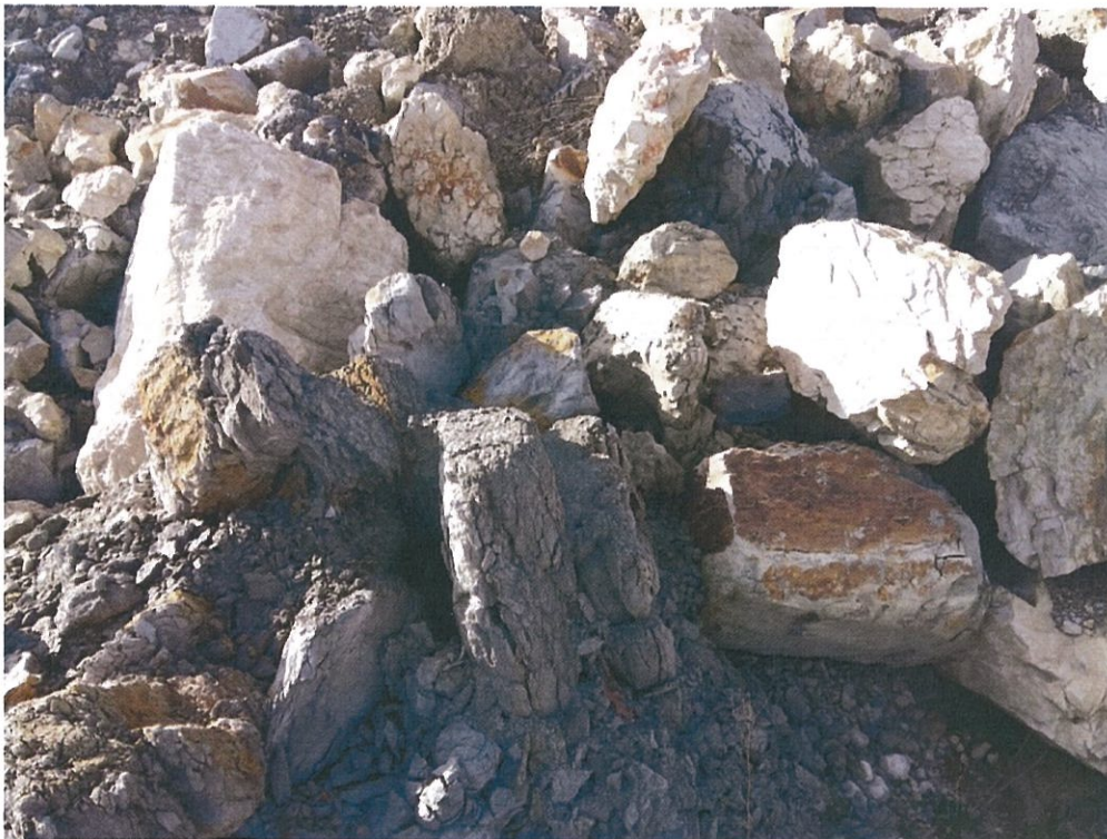
Foto 2 – Dettaglio dei due tipi di marna presenti in miniera. Marna alta (chiara), marna bassa (grigia).
