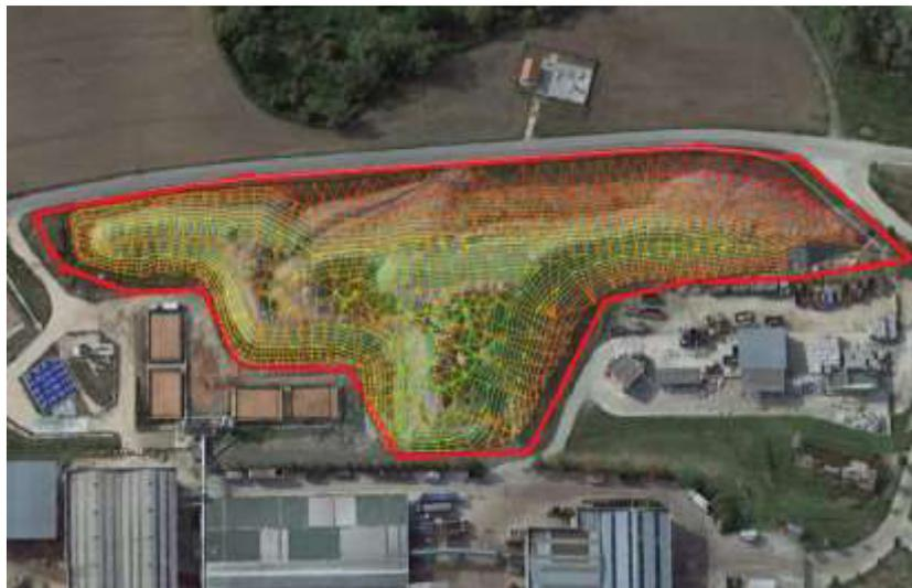
Fig. 3: ubicazione del cumulo di 128.000 mc (superficie di circa 20.000 mq) nel polo impiantistico del CIVETA - estratto dalla relazione tecnica
