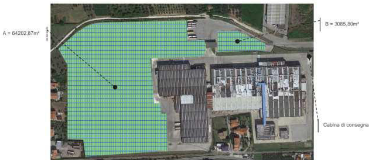
Figura 4 - Aree d'installazione dell'impianto FTV presso Ontex Manufacturing Italy S.r.l.
