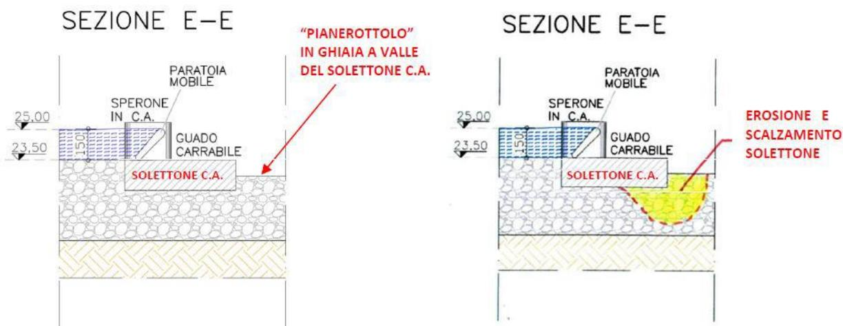
Figura 3: Confronto per la sez. E-E dell'attività erosiva rilevata a seguito degli eventi eccezionali susseguitisi.
